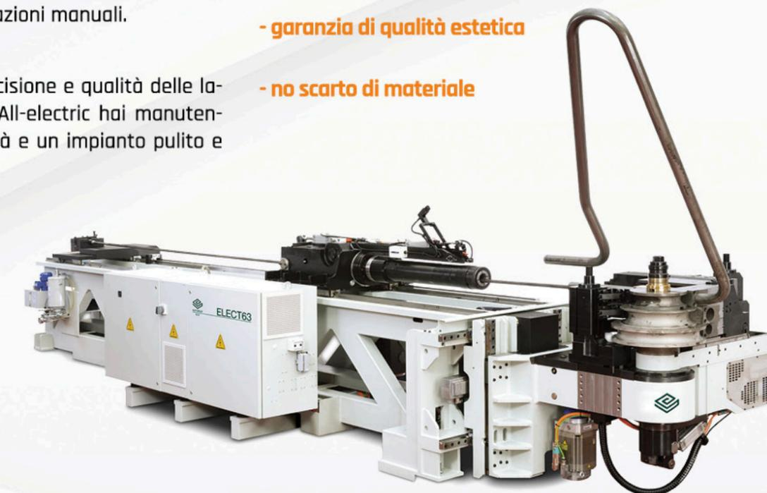
La macchina **Elect 63** lavora in multi raggio, con raggio fisso e variabile. La macchina presenta la possibilità di montare fino a **8 attrezzature contemporaneamente**.
